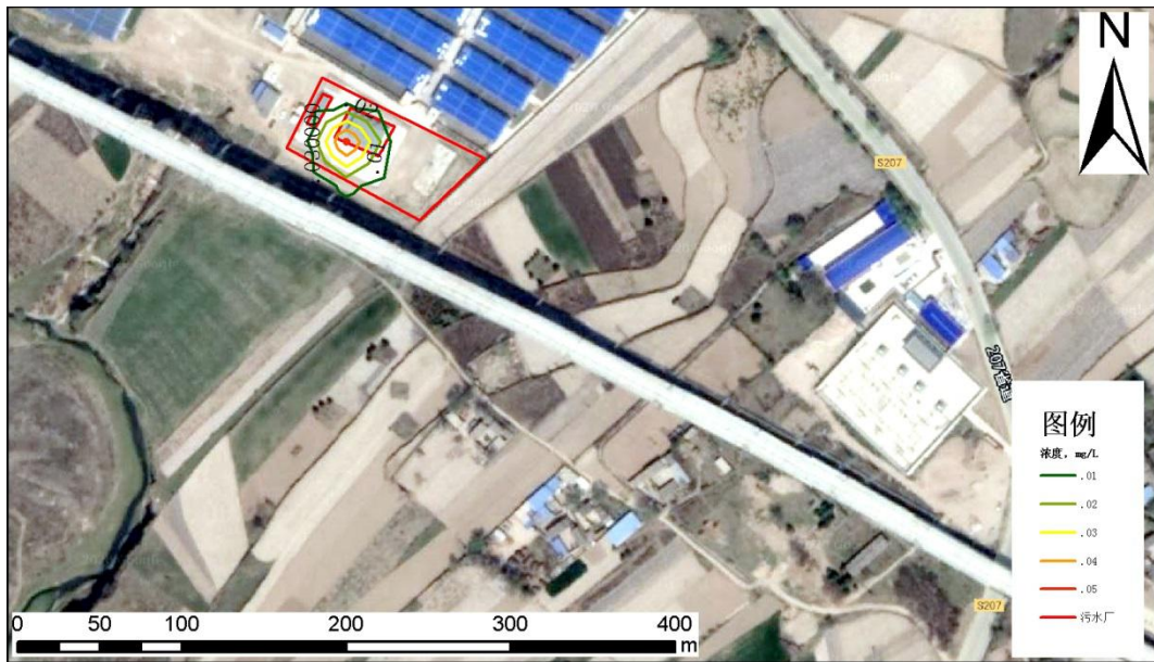
图4.2-16 非正常工况发生后100d氨氮浓度分布等值线
